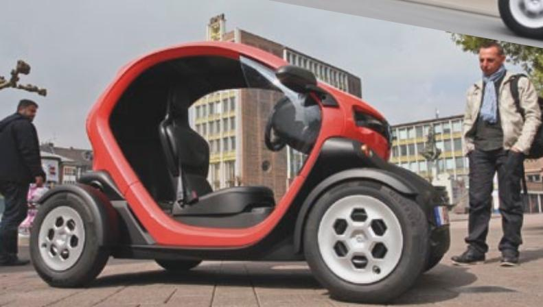
nur 1,2 Meter Breite ein völlig neues Fahrzeuglayout für den Innenstadtverkehr. Fahrer und Beifahrer sitzen hintereinander in einer hochsteifen Sicherheitsfahrgelegenheit. Auf diese Weise benötigt der vier-rädrige Citystromer so wenig Verkehrsfläche wie ein großer Motorroller und bewegt sich mit lediglich 3,4 Meter Wenderradius äußerst agil im Straßenverkehr.
