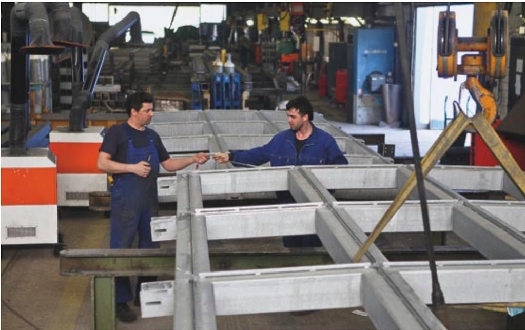
Hydraulikzange wird der Stahl verformt und die Elemente fest "für die Ewigkeit" verbunden. Zusammen mit Spezialisten der Wuppertaler Schwebbahn wurde das Verfahren ausgiebig getestet, bevor es an die eigentliche Aufgabe ging, mit Dürener Nieten die Stahlträger zu verbinden.
