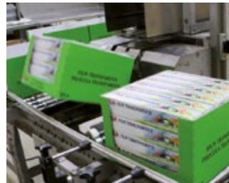
endgültige Verpackung. Diese wird, in der jeweiligen Kundenanmeldung, flach angeliefert, wird automatisch gefaltet, verklebt und verschlossen und im Trays verpackt.
